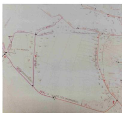
Il a été constaté qu'aucune canalisation ne desserre le chemin du Mommin dans sa totalité, une pose de canalisation à partir de la rue des Ecoles pour rejoindre le réseau existant dans chemin du Mommin (côté rue des Ecureuils)
